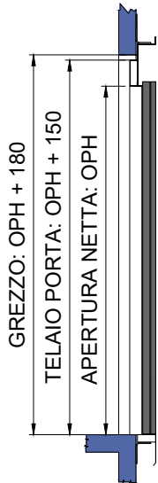
SEZIONE TELAIIO PORTE MRF 150
