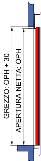
SEZIONE TELAIIO PORTE NF (EI120)
